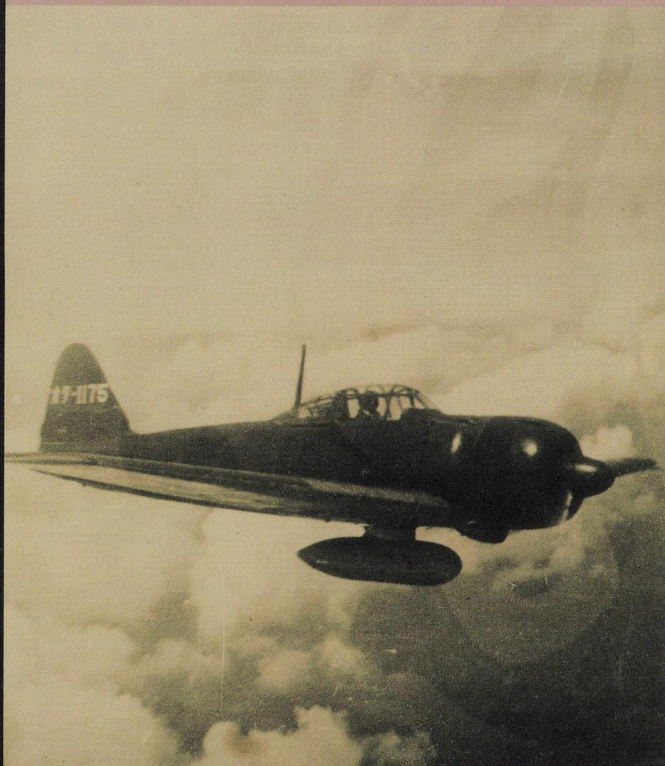
陸上基地用に改良、速度・高空性能をアップさせた零式艦上戦闘機三二型の勇姿。
