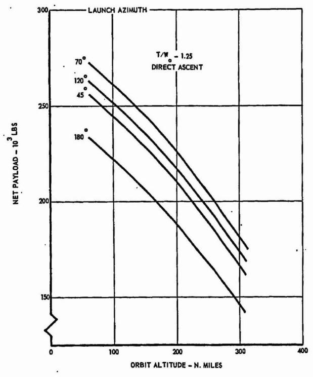
ORBIT ALTITUDE - AZIMUTH
