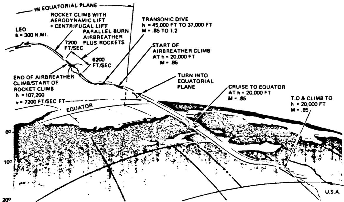
Figure 1.3-8. SSTO Trajectory
